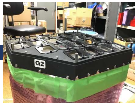
新支えパーツ、枠体、窓枠を取り付けたところ
