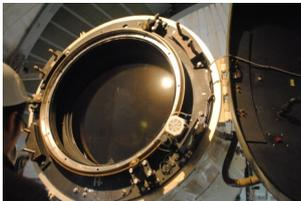
図4：シュミット望遠鏡の補正板
