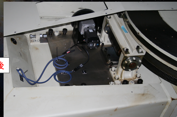
DEC軸 駆動モーター、ギヤ部
