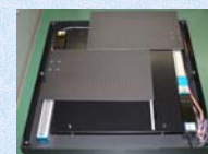
2k×4k CCDを8枚カバーできる大型シャッター (左: 概観、中: 内部 (閉時)、右: 内部 (開時)) カメラのシャッターは露出ムラがなくなるよう2枚のシャッター板を縦方向にスライドさせる。その結果CCDのどの部分も全て同じ露出時間となる。最短0.1秒 (精度1%) の開口が可能である。
