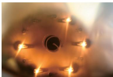
図8. フィラメントを加熱しアルミを蒸着
