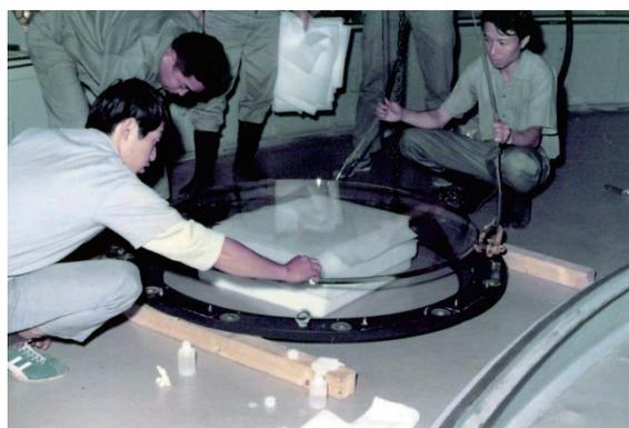
図13. 補正板取り付け
