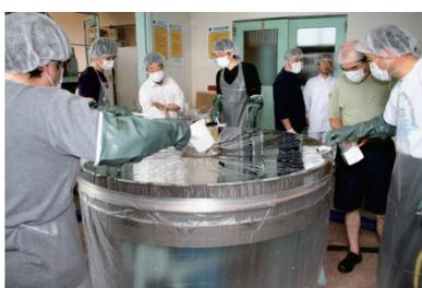
図4. 苛性ソーダでアルミ膜を剥がす
