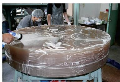
図5. 重炭酸ナトリウムで鏡面を磨く
