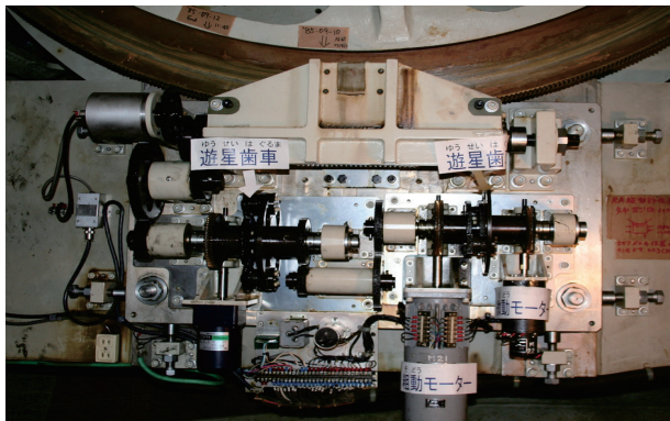
図1. 改修前のRA駆動系(所狭しと並んだ各種モーター)
