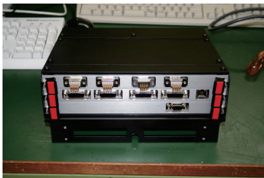
KAC (Kiso Array Controller)：KWFCC の 2 種類の CCD をドライブするユニット。検出器によりドライブ電圧等が異なるが、KAC はプログラマブルにそれらを調整できる。
