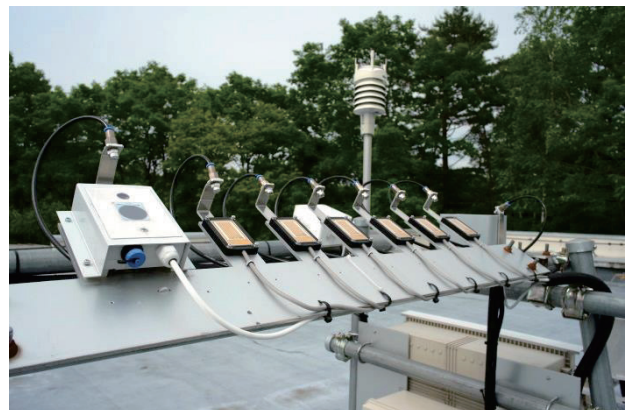
図 2. 雲センサー（手前の白い装置）と雨滴センサー（中央から奥にかけて並んでいる装置）および気象ステーション（支柱の上に設置されている白い装置）
