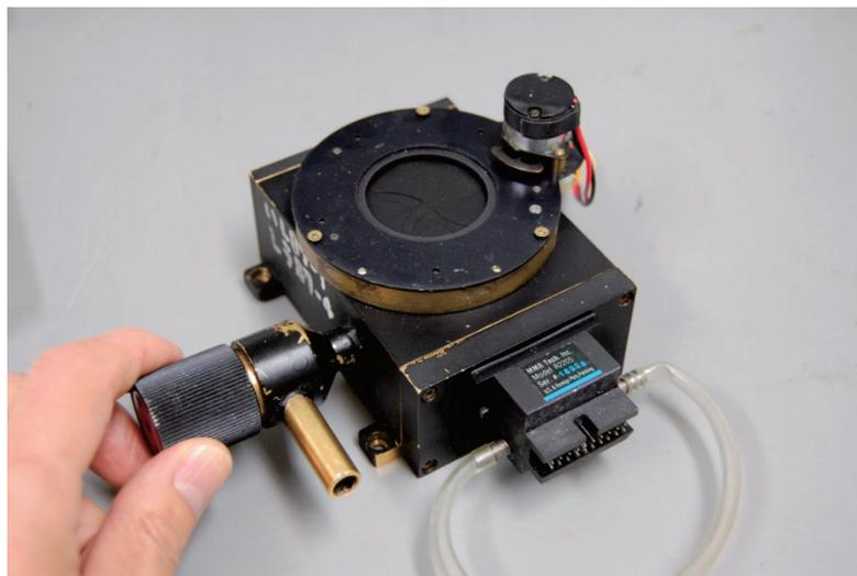
**木曾 CCD デューワー：** 手で挟んでいるのが真空バルブ。デューワー窓上部にシャッター、手との比較でわかるように非常にコンパクトなデューワーである。バルブ等の凸を含めた外寸は 150mm(W) × 130mm(L) × 70mm(H)。
