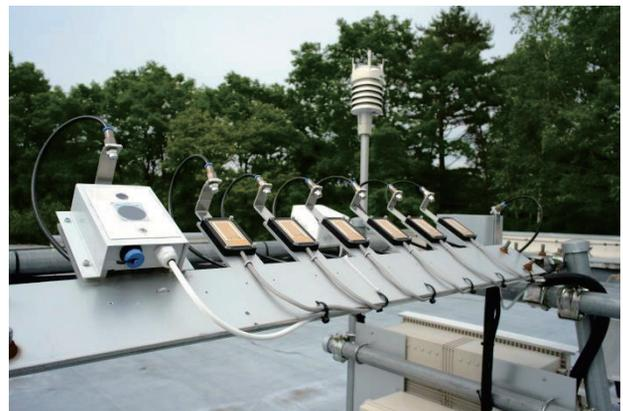
図 2. 雲センサー（手前の白い装置）と雨滴センサー（中央から奥にかけて並んでいる装置）および気象ステーション（支柱の上に設置されている白い装置）
