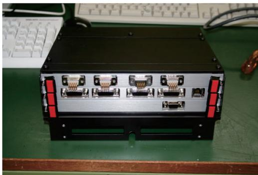
KAC (Kiso Array Controller)：KWFC の2種類の CCD をドライブするユニット。検出器によりドライブ電圧等が異なるが、KAC はプログラマブルにそれらを調整できる。
