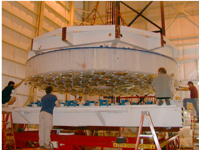
図 3.3: TAO 望遠鏡主鏡と同型の Magellan 2 望遠鏡主鏡 (口径 6.5m)
