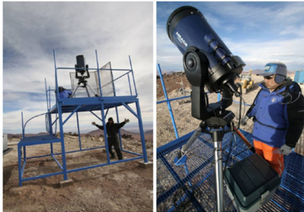
図 5.11: 山頂タワーに設置されたシーイングモニタ.
