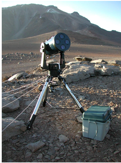
図 5.13: シーイングモニタをセットアップしたところ (アタカマにて)
