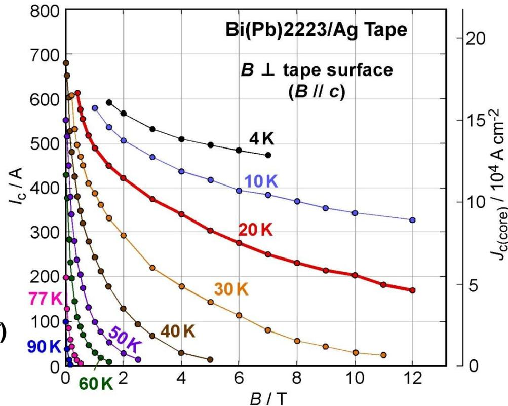
$I_c$  (77 K, s.f.) : ~ 200 A ( $4 \text{ mm}^w \times 0.25 \text{ mm}^t$ )
