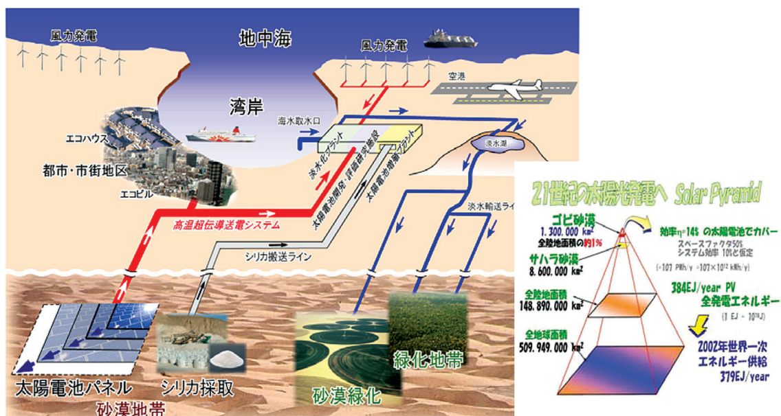
図4 Sahara Solar Breeder 計画の概念図。右下は沙漠における潜在的太陽光発電エネルギーの大きさを表したものである
